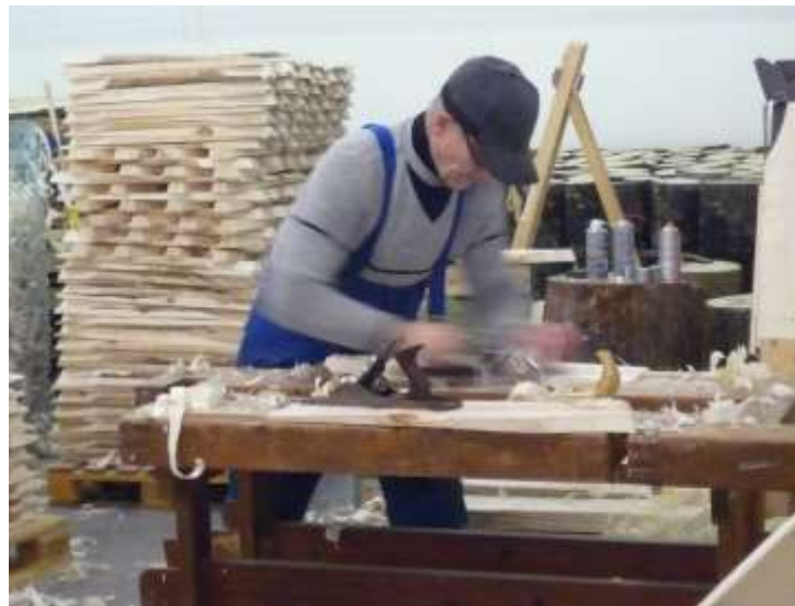
Kaustisen kirkon paanuja veistettiin talkoilla.
